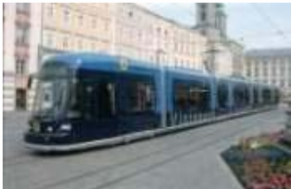
100% Niederflur (Linz, Österreich)
