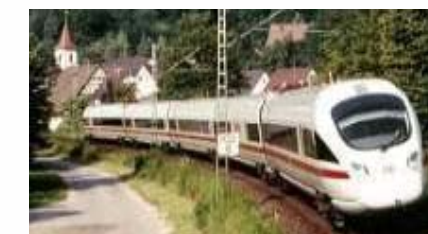
Triebzug ICE T , mit Neigetechnik (Deutschland)
